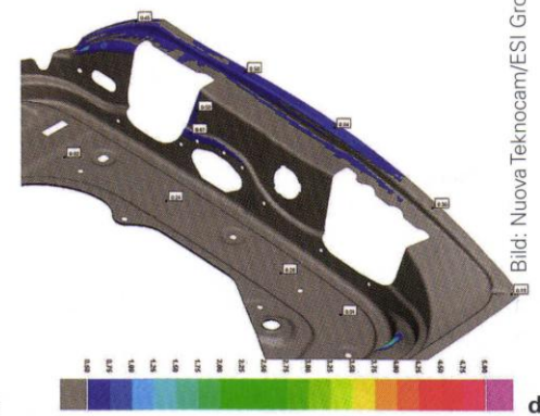
Rückfederungskompensation an einer Autotür: a Kompensation, b, c und d letzte Stufe mit Rückfederungskompensation.
